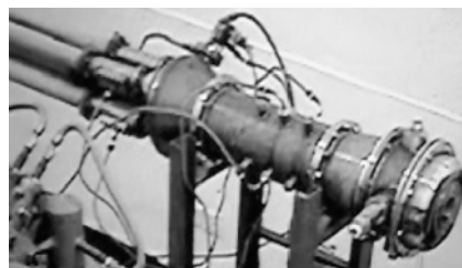
图 1 两级 PDE 三维激波会聚起爆实验系统照片
